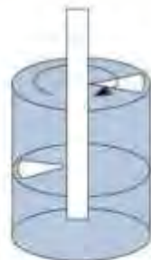
Jet Grout (Erosion)
